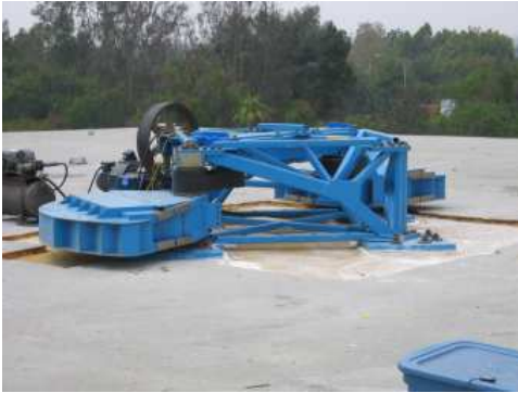
Fig. 15. Eccentric mass shakers
